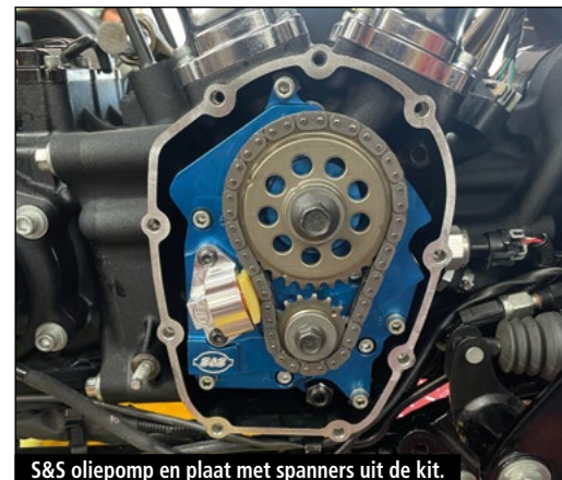
S&S oliepomp en plaat met spanners uit de kit.
