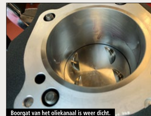
Boorgat van het oliekanaal is weer dicht.
