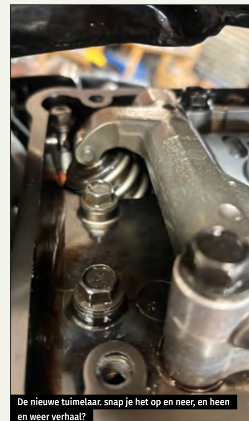
De S&S rockers met een rol aan de kant van de klep.
