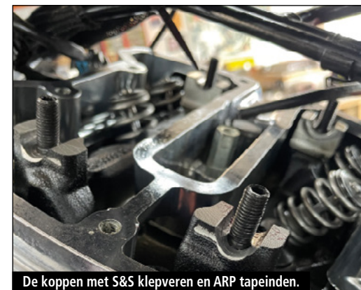
De koppen met S&S kleppen en ARP tapeinden.
