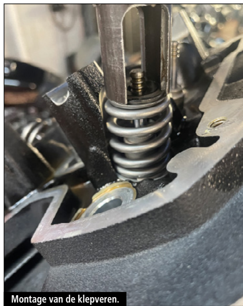
Montage van de kleppen.
