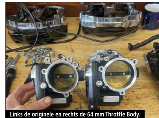
Links de originele en rechts de 64 mm Throttle Body.
