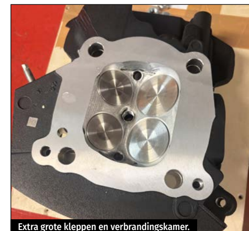
Extra grote kleppen en verbrandingskamer.
