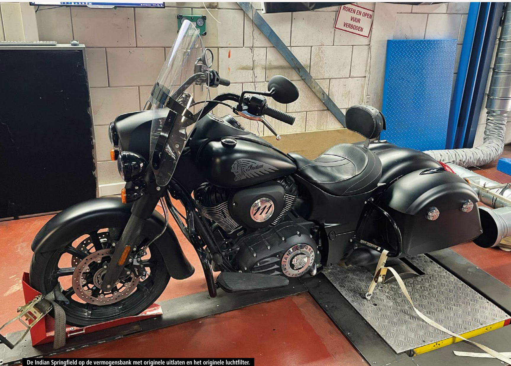
De Indian Springfield op de vermogensbank met originele uitlaten en het originele luchtfilter.
