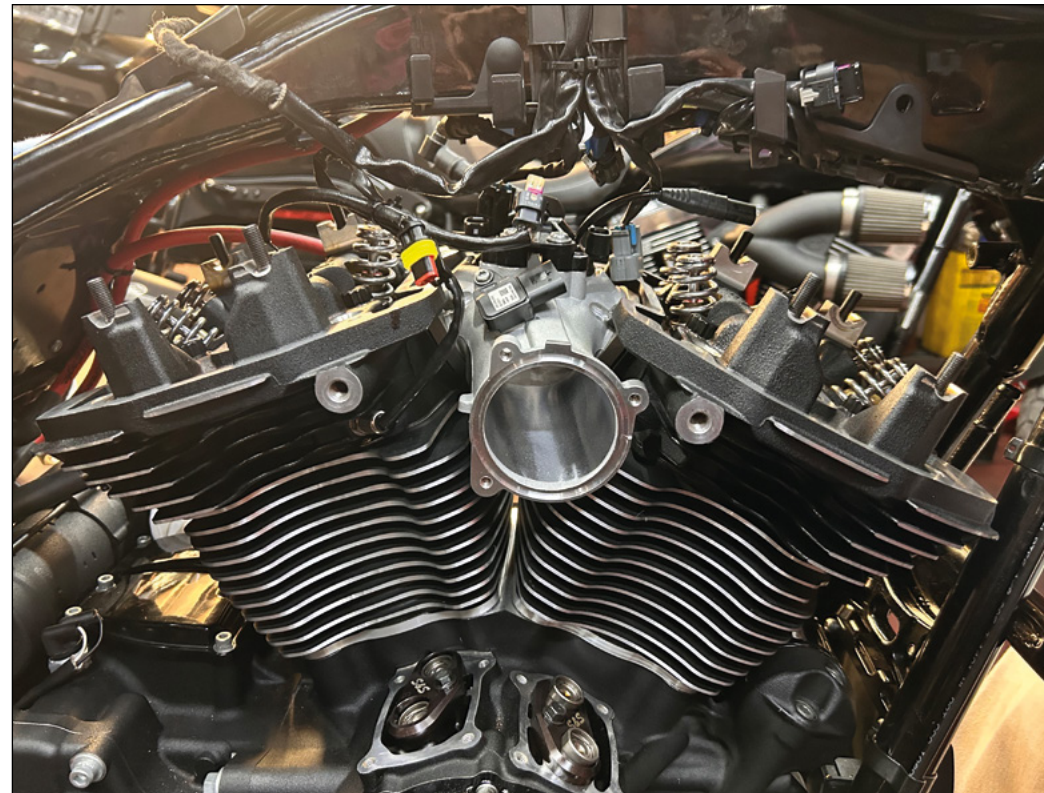
De Star klepveren, de tapeinden van de tuimelaars en het grote CNC spuitstuk van Screaming Eagle zijn hier goed te zien.
